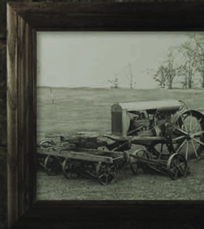
La fameuse tondeuse Minikahda de 1921. En joignant cinq tondeuses à gazon à l'avant d'un tracteur agricole, Toro® marqua le début de l'industrie du matériel motorisé pour terrain de golf.
