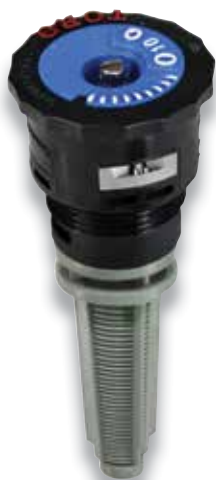
Buse à haut débit concurrente : Buse 12H à 3,4 bars = 6,93 L/min ou 62 mm/h.*
